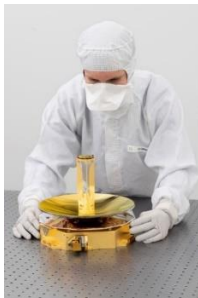
Abb. 1 & 2: Für das Laser Altimeter GALA wurde am Fraunhofer IOF in Jena ein Spiegelteleskop entwickelt. © Fraunhofer IOF
