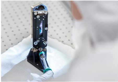
Der Doppelspalt wurde aus Silizium gefertigt und mit einer schwarzen Beschichtung versehen. © Fraunhofer IOF
