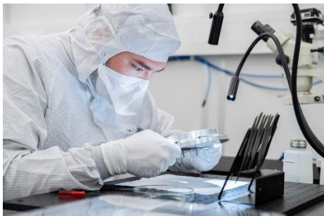
Die Doppelspalt-Vorrichtung wird in einer mechanischen Halterung montiert. © Fraunhofer IOF
