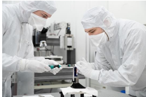
Die fragilen Schlitze müssen hochparallel zueinander installiert und zugleich robust gegen extreme Umweltbedingungen im All sein. © Fraunhofer IOF
