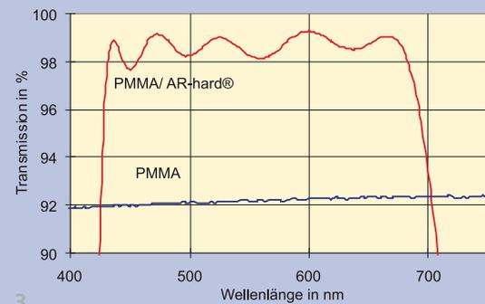
1 Transmission einer beidseitig entspiegelten PMMA-Probe (4-Schicht-Design).
