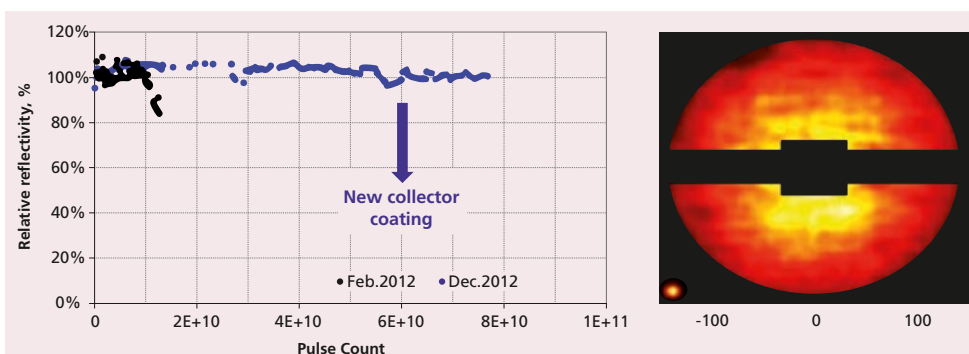
2 Neue Multilayer-Beschichtungen erhöhen die Kollektorlebensdauer auf über 8 \cdot 10^{10} Pulse (links); EUV Reflexion nach 80 Mrd. Pulsen. © Cymer Inc (rechts). | New multilayer coating designs allow extended collector lifetime to > 8 \cdot 10^{10} pulses (left). EUV collector far field image at 80 billion pulses. © Cymer Inc. (right).
